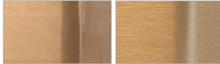
Vergleich: ungeprägte Folie (links) und geprägte Folie (rechts)
